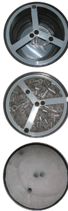
Exemples de guides d'insertion pour des sources filaires Examples of insertion guides for filiform sources
