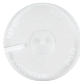
Source utilisée dans le CRAB. Référence EGS09HS © LEA Source used in the Beta and Gamma Radiation Counter
