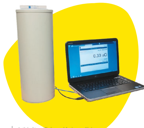
Activimètre utilisé en médecine nucléaire pour connaître avec précision l'activité administrée aux patients | Dose calibrator used in nuclear medicine to know with precision the activity administered to patients © ORION-France
