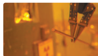
Télémanipulation de sources de rayonnement gamma utilisé pour étudier le comportement de matériaux sous irradiation © IRSN Saclay Remote handling of sources of gamma radiation used to study materials' behavior under irradiation.
