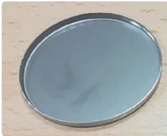
Coupelle de diamètre 47 mm fournie par le client 1.9 in (47 mm) diameter planchet provided by the customer
